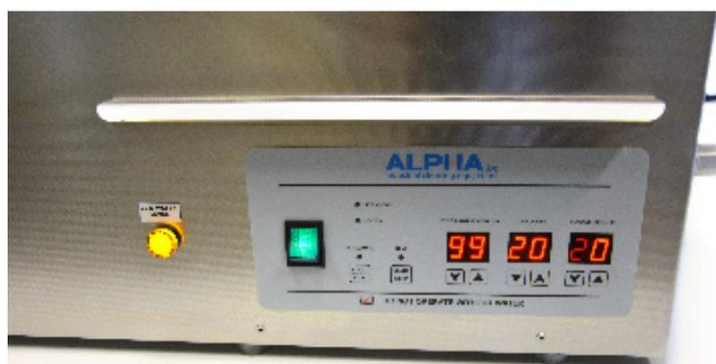
*commande numérique avec puissance réglable et détection de niveau*
