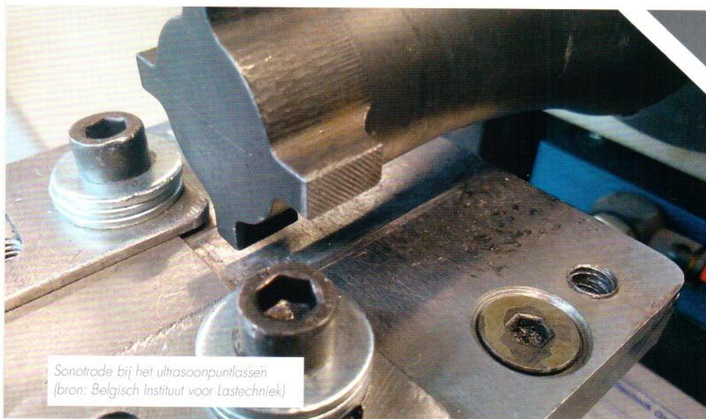
Ultrasoonlas van koper aan zilvergecoat koper
