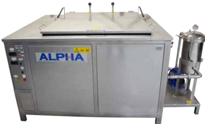
AIC-500 litres sur mesure équipé d'une pompe avec filtre
